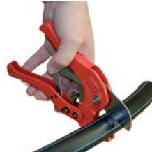
1. Couper le tube PE avec un coupe tube approprié. La section du tube doit être propre et ébavurée.
