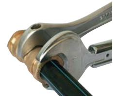
4. Serrer l'écrou sur le corps du raccord à l'aide de deux clés sans excéder un couple de serrage de 20 Nm.
