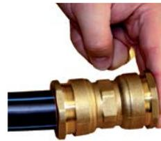
3. Insérer le tube dans le raccord jusqu'à la butée (repère d'emboîtement), après avoir desserré l'écrou de quelques filets.
